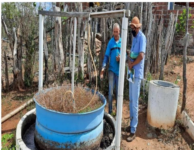
**Biodigestor utilizado para produção de biofertilizante em comunidade ribeirinha**
